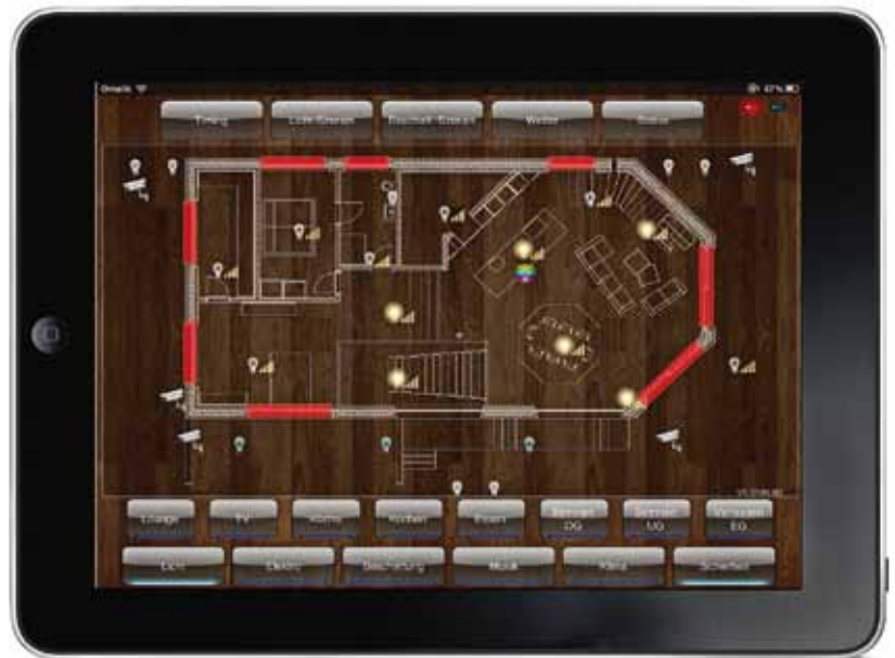
Das iPad bietet eine übersichtliche Steuerung der Gebäudeautomation.
